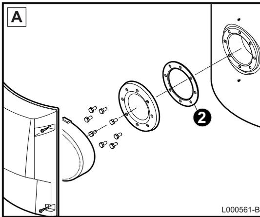
2. Die Dichtungsscheibe ersetzen.
