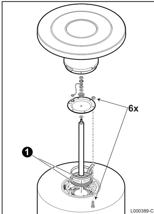
1. Die Einheit aus Lippendichtung+Sprengring ersetzen und in das Reinigungsloch einsetzen, dabei darauf achten, die Lasche der Lippendichtung außerhalb des Warmwassererwärmers zu positionieren.
