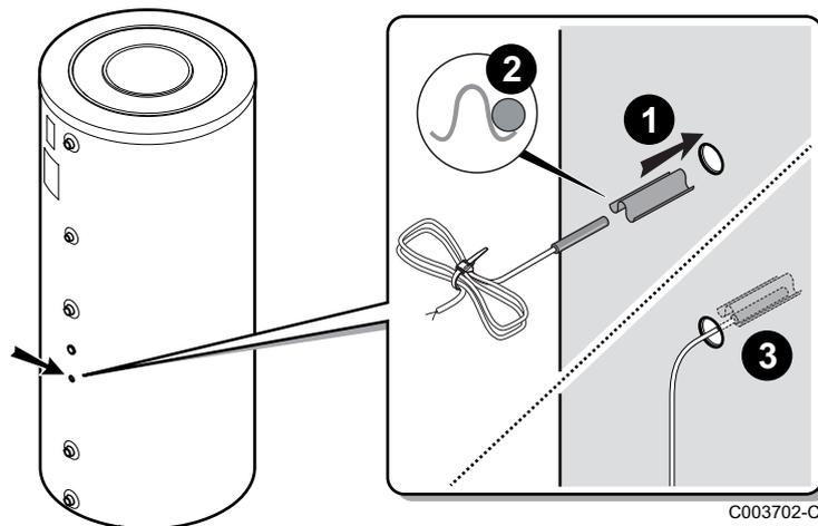
1. Den Fühler mittels der Kontaktfeder für die Tauchhülse in die Tauchhülse einsetzen.
